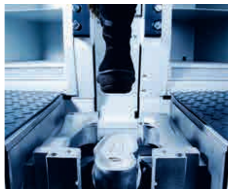
DESMA-установка для прямого прилива подошв
